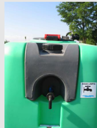
Serbatoio di acqua pulita a disposizione dell'operatore ("lavamani") (Foto Cons. Fito. Reggio Emilia)
