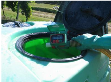
Riempimento dell'atomizzatore con flussometro per l'esatta misurazione della quantità d'acqua introdotta nella botte (Foto Cons. Fito. Reggio Emilia)
