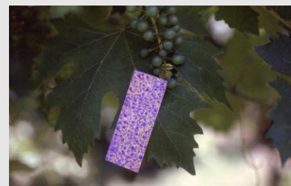
Cartine idrosensibili per rilevare la bagnatura durante i trattamenti (Foto Cons. Fito. Reggio Emilia)
