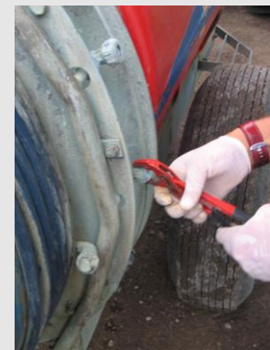
Manutenzione degli ugelli durante il controllo funzionale (Foto Cons. Fito. Reggio Emilia)
