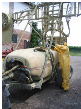
Corretta preparazione della miscela e riempimento dell'irroratrice (Foto Cons. Fito. Reggio Emilia)
