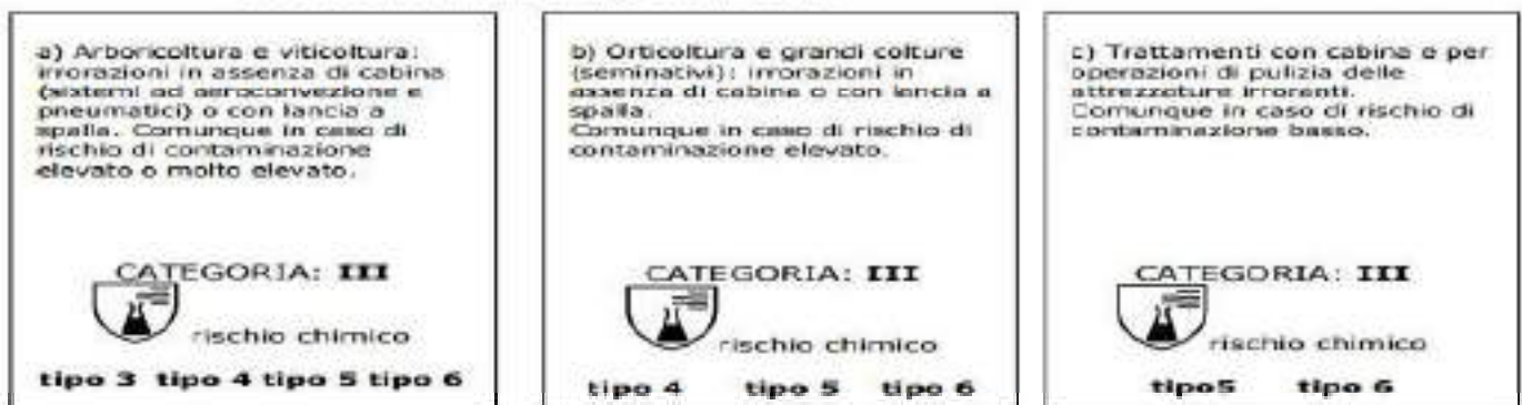
Figura 1: Esempi di protezione relativi pittogrammi per gli indumenti utilizzabili nelle più comuni pratiche fitosanitarie in funzione del tipo di esposizione
