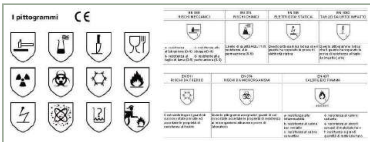
Su ogni DPI viene riportato un pittogramma che indica la protezione dal rischio e i livelli prestazionali indicati da numeri.
