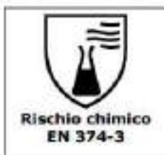
Figura 2: Tipi di protezione e pittogrammi relativi ai guanti
